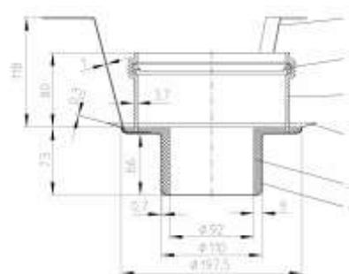
Рис. 4. Противопожарная муфта HL850 для кровельной воронки HL62F/7.
