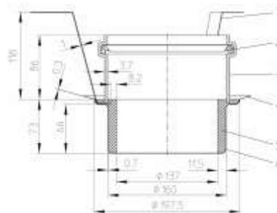
Рис. 5. Противопожарная муфта HL870 для кровельной воронки HL62F/1.
