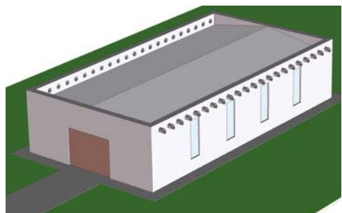
**Пример 3: Система аварийного водостока на основе специальных воронок (HL..PowerSafe) устанавливаемых у парапета, с присоединённым вертикальным выпуском высотой 3 м**
