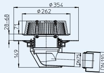
Пропускная способность измерена в соответствии с DIN EN 1253 с вертикальным выпускным патрубком длиной 3 м.
