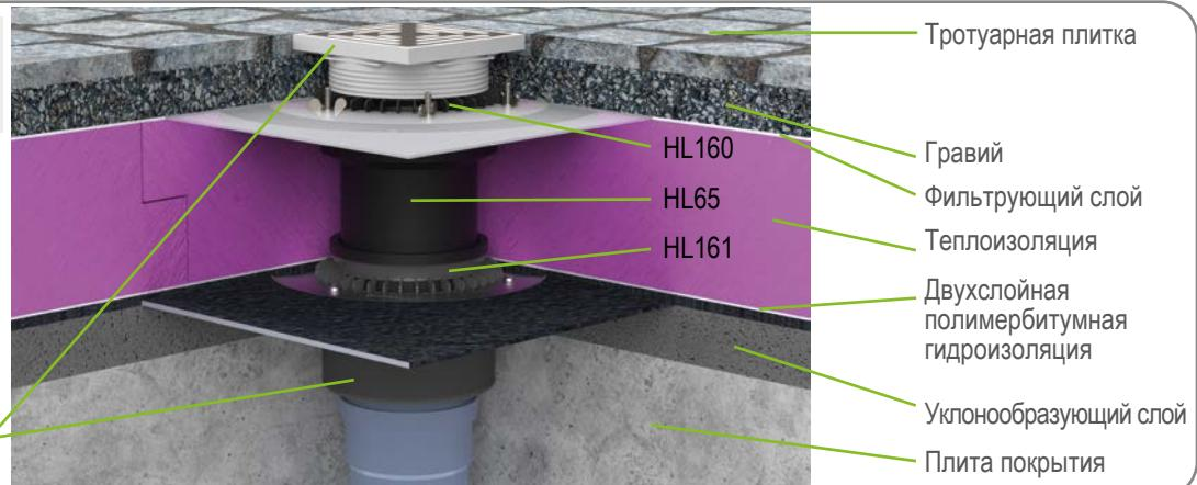
**Эксплуатируемая инверсионная кровля с дренажным и инспекционным колодцем**
