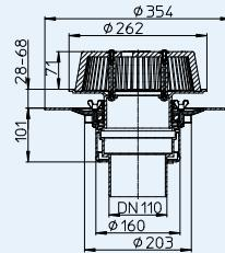
Пропускная способность измерена в соответствии с DIN EN 1253 с вертикальным выпускным патрубком длиной 3 м.
