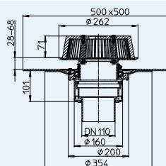
Пропускная способность измерена в соответствии с DIN EN 1253 с вертикальным выпускным патрубком длиной 3 м.
