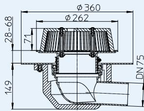
Пропускная способность измерена в соответствии с DIN EN 1253 с вертикальным выпускным патрубком длиной 3 м.
