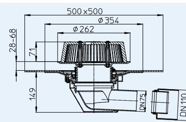
Пропускная способность измерена в соответствии с DIN EN 1253 с вертикальным выпускным патрубком длиной 3 м.
