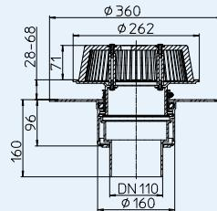
Пропускная способность измерена в соответствии с DIN EN 1253 с вертикальным выпускным патрубком длиной 3 м.
