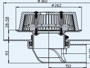
Пропускная способность измерена в соответствии с DIN EN 1253 с вертикальным выпускным патрубком длиной 3 м.
