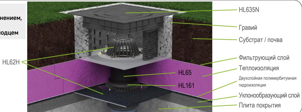
**“Зелёная” кровля с интенсивным озеленением для аварийного водостока, с дренажным и инспекционным колодцем**
