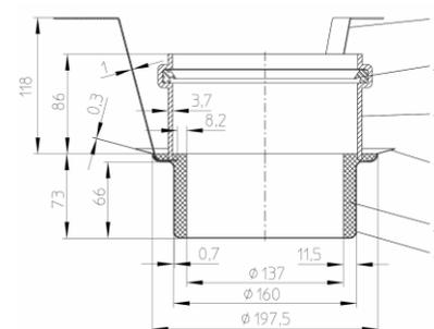
Рис. 6. Противопожарная муфта HL870 для кровельной воронки HL62.1P/1.
