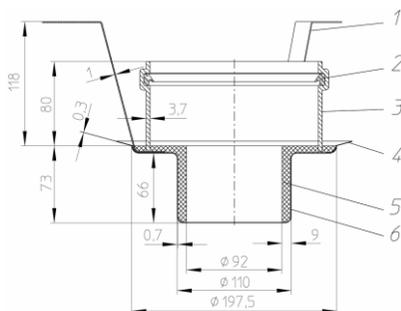
Рис. 5. Противопожарная муфта HL850 для кровельной воронки HL62.1P/7.
