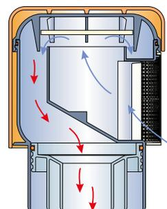
При возникновении разрежения в стояке (более 5 мм вод. столба) клапан открывается и пропускает воздух в стояк, а при выравнивании давления снова закрывается.
