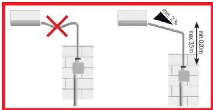
Рис. 2. Схема монтажа сифона HL138NH.
