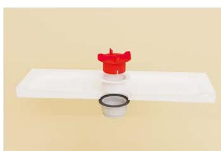
12. Перед установкой душевого поддона вставить корпус гидрозатвора в отверстие поддона и ввернуть его в контргайку. Уплотнительная прокладка должна плотно прилегать снизу к душевому поддону.
