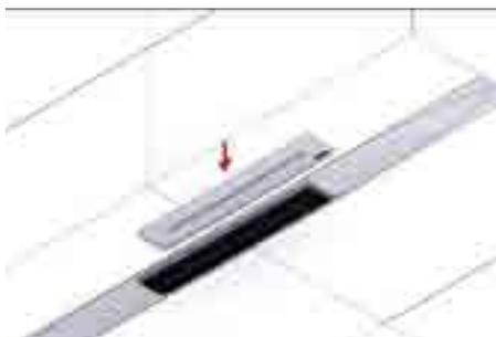
11. Установить съёмную крышку из нержавеющей стали - Всё готово!
