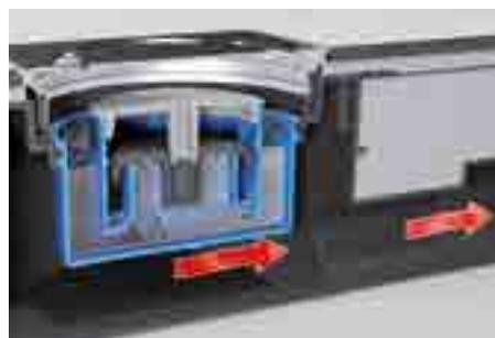
При возникновении разрежения в канализационных трубопроводах тарелка клапана (a) под собственным весом прижимается к корпусу и препятствует высасыванию воды из сифона
