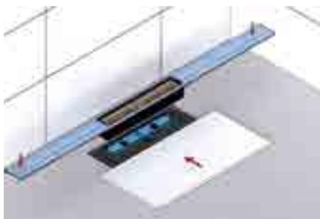
7. Отрегулировать высоту установки решётки из нержавеющей стали с учетом толщины напольной плитки и плиточного клея путем подрезания монтажного короба, установить специальные подкладки по краям решетки
