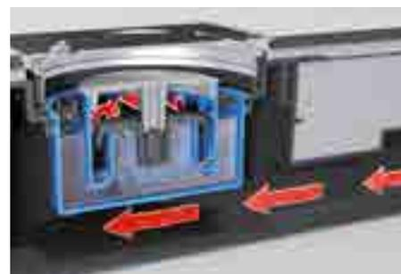
При возникновении избыточного давления в отводящем трубопроводе тарелка клапана (a) прижимается к корпусу и не пропускает запах из канализации. Дополнительное преимущество: Primus blue защищает от обратного тока воды (подтопления)
