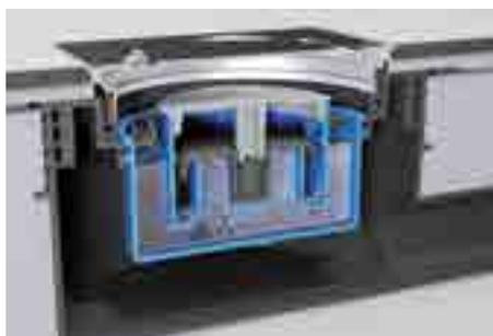
Когда слив воды прекращается, то тарелка клапана (a) опускается на корпус клапана и не пропускает запах из канализации
